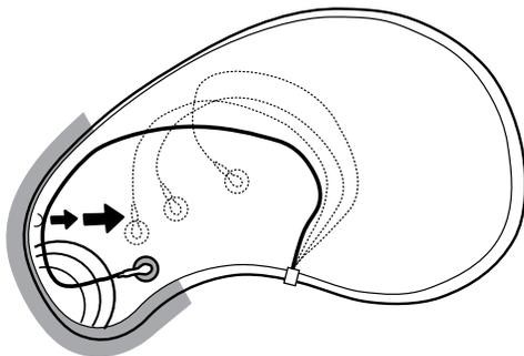
On peut utiliser une conduite de retour pour écarter l'appareil de nettoyage des escaliers ou des zones à coins en V et pour réduire les évolutions à répétition.
