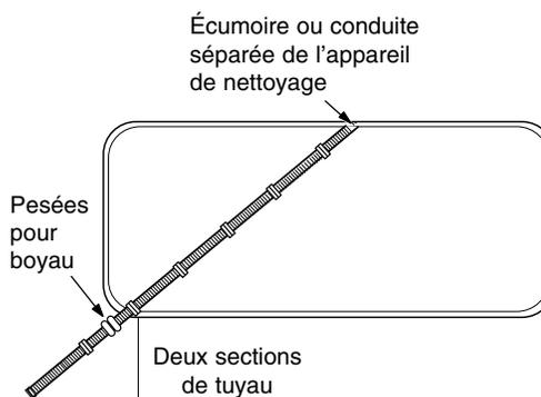
Positionnez le(s) poids de boyau, deux pour les installations aux É.-U. / au Mexique et un pour les installations au Canada, au milieu de la deuxième section de boyau, environ 1,5 m (60 po) derrière l'extrémité du boyau.
