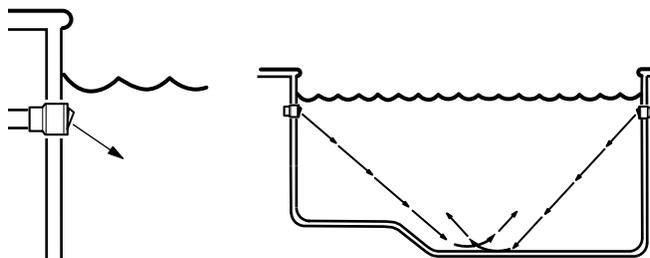
Si les jets de refoulement ne peuvent pas être ajustés, les jets de refoulement doivent être remplacés par un déflecteur de retour (pièce no. W90153 pour 1-1/2 po., no. W90155 pour 2 po. ou no. W24100 pour les piscines sans raccord de retour).
